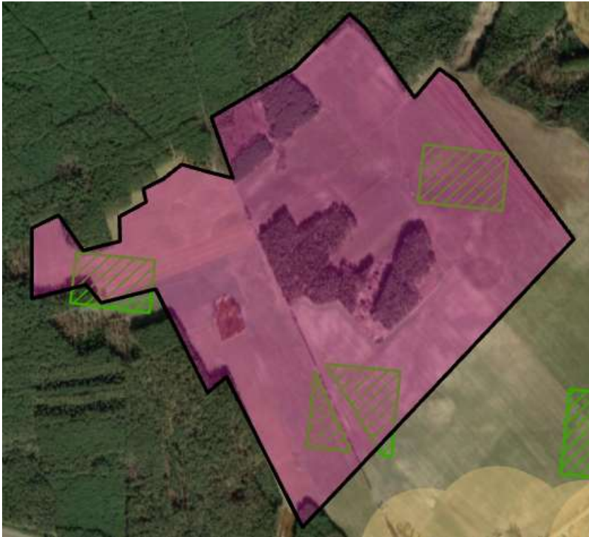
Kartografische Analyse des Standorts für die PV-FFA (■) anhand des Kriteriengerüsts für die PV-FFA in dem VBP „Sondergebiet Solarpark Diehlo“
